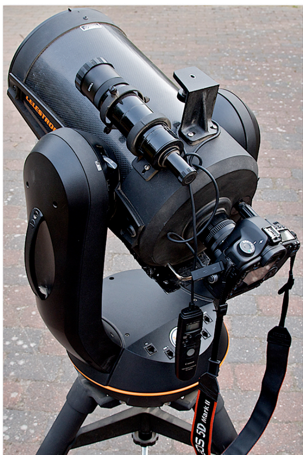
Celestron NexStar 8 GPS teleskop med f/6,3 focal reducer, T-EOS adapter og Canon EOS 5D mark II med udløseren TC80N3.
